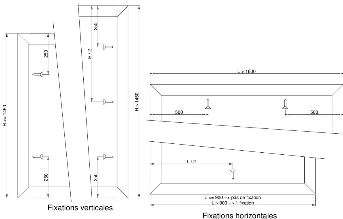
**Après fixation, les tolérances géométriques (verticale, horizontale, diagonale, planéité) du châssis doivent être inférieures à +/- 2mm par mètre**
